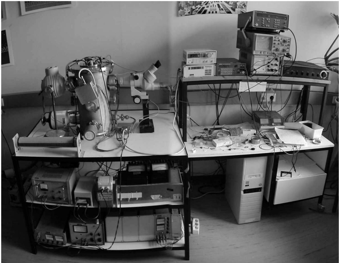
**Abb. 1.1:** Die Fotomontage aus zwei Bildern zeigt die vollständige Meßapparatur zur kombinierten Dilatometrie und Vibrating-Reed-Messung.
